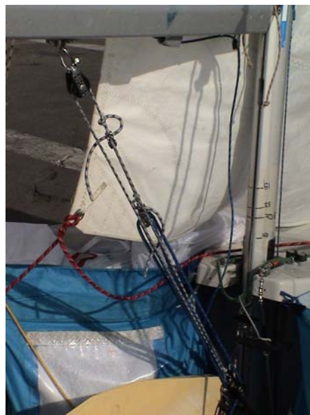
Figura 6 – exemplo de sistema de boom-jack
