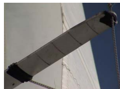
Figura 12 – marcas nos vaus
