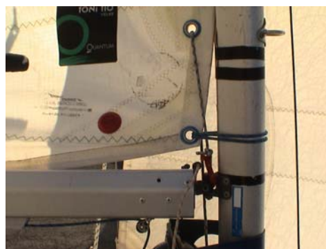
Figura 22 – punho da amura na posição “médio”
