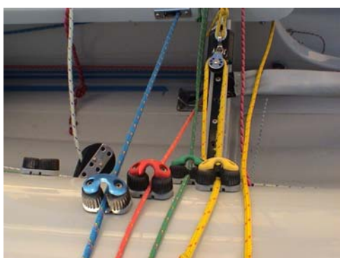
Figura 21 – boom-jack, cunningham da grande, carrinho de estai e carrinho da grande colocados à vante do timoneiro
