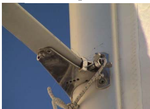
Figura 15 – sistema de afinção dos vaus
