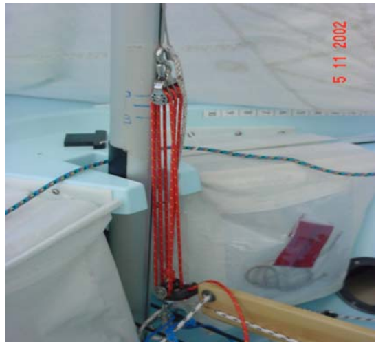
Figura 14 – sistema de tensão
